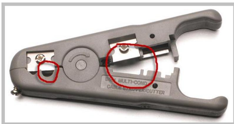
Принцип тут тот же: кладете кабель в специальное углубление на инструменте, фиксируете его там и проворачиваете инструмент вокруг своей оси, а лезвие в этот момент аккуратно срезает изоляцию по кругу. Стягиваете изоляцию и продолжаете работать с жилками кабеля.
