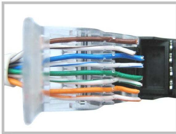
Когда все провода распределены, закрываем наш модуль и **сильно** сдавливаем. **Помните!** Для достижения оптимального результата, лезвия должны за одно нажатие прорезать все восемь пар изоляции жил кабеля, так что усилие должно быть достаточно значительным. Нам надо чтобы пластмассовый фиксатор на прозрачной части модуля защелкнулся выше его части с лезвиями (черной), тем самым исключая самопроизвольное открытие модуля.
