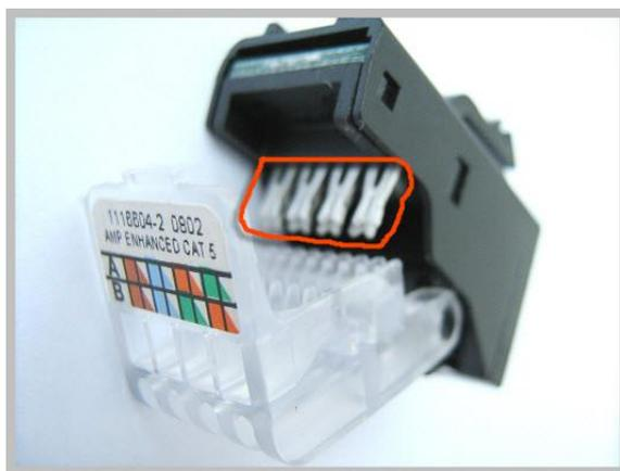
На заднем плане мы видим восемь, лезвий модуля, каждое из которых прорезая изоляцию кабеля, обеспечивает электрический контакт с его медным сердечником (как в случае с патч панелью, помните?).
