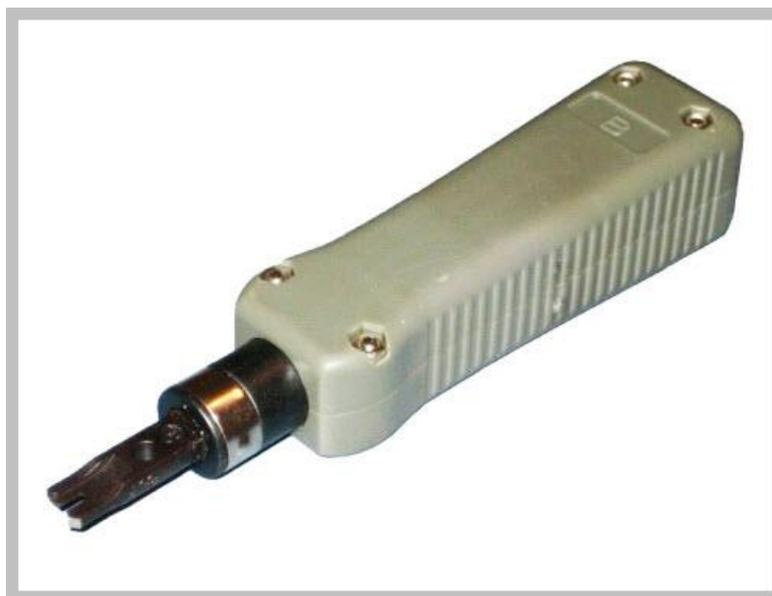
Наиболее точно принцип его работы действительно можно охарактеризовать, как «забивание». Каждая из восьми ячеек модуля панели оснащена металлической вставкой в форма английской буквы «V», на внутренних поверхностях которой расположены два
