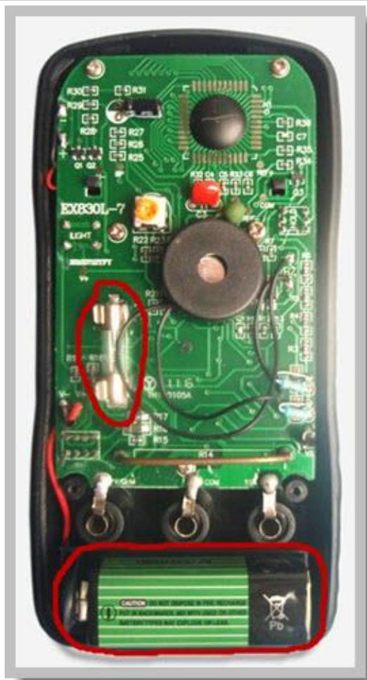
Внизу красным обведен наш элемент питания, а сверху - плавкий предохранитель, который (я надеюсь) защитит наш измеритель от выхода из строя в случае перегрузки.
