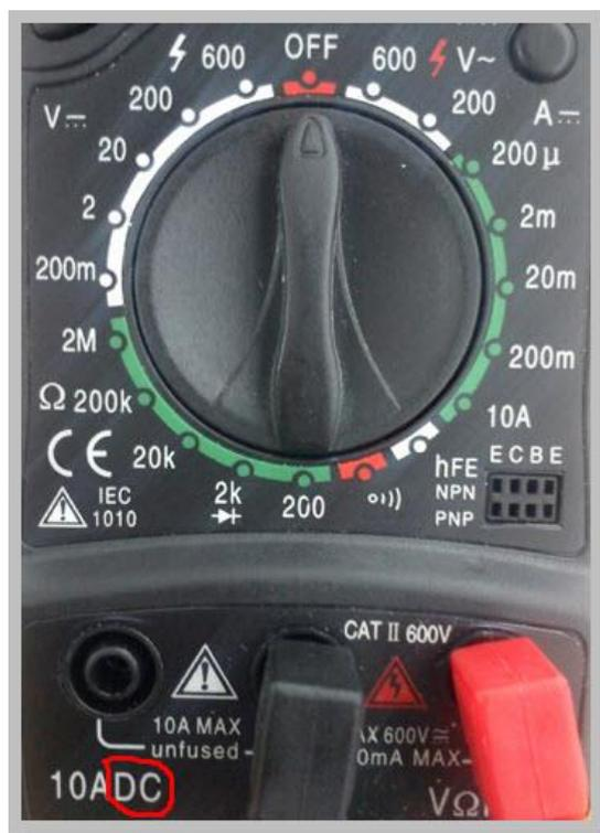
Видите - две буквы «DC» в левом нижнем углу на фото выше? Это значит что левее (относительно положения «OFF») мы будем работать с мультиметром, измеряя постоянные значения напряжения и силы тока. Соответственно правая часть мультитестера отвечает за измерения тока переменного.
